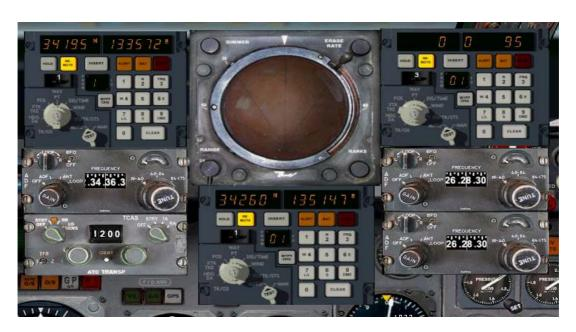
CDU DISPLAY KNOB를 WAYPT로 돌린 후에 FIX 선택 KNOB(숫자 KNOB)를 1로 돌려줍니다. 그렇다면 좌표에 000000 0000000 이렇게 뜰겁니다. 이제 1번 FIX에 우리의 첫 FIX의 좌표를 입력해줍니다. 근데 좌표는 어디서 구하냐구요? 컴퓨터 바탕화면의 내문서/FlightSimulator Files에 가시면 자신이 저장해놓은 Flight Plan 파일이 있을겁니다. 그 파일 중 내가 이번 비행에 쓸 파일을 열면 이런 것이 뜰 겁니다.
