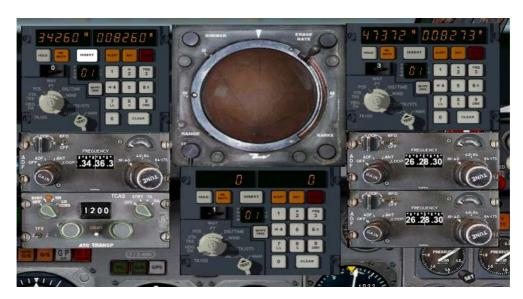
이제 제대로 된 좌표를 입력해줘야겠죠. 각 CDU Display KNOB를 POS 위치에 둡니다. 그리고 위도 좌표를 먼저 입력해줍니다. 북반구에 있을 때는 N 즉 숫자패드의 2(N)을 눌러준 후 위도 좌표를 넣어줍니다. 남반구는 그 반대로 S 즉 숫자패드 8(S)를 눌러줍니다. 그렇다면 하얀색 Insert 버튼에 불이들어오면서 00000N 이라는 글이 뜨게 됩니다. 그렇다면 우리가 현재 위치하고 있는 곳의 위도 좌표를 입력해주면 됩니다. 좌표가 다 입력되었으면 불이 들어온 Insert 버튼을 눌러줍니다. 그렇다면 위도는 다 입력이 된거고.. 아마 Insert 버튼에 계속 불이들어와있을 겁니다. 빨리 경도 좌표도 넣어달라는 소리겠죠.
