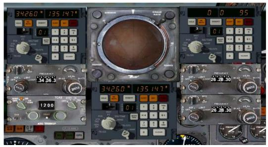
자.. 이제 INS를 ALIGN 모드로 넘어갔는데 ALIGN이 다 되려면 약 15분을 기다려야 합니다. CDU-2를 보시면 0 0 95라고 적힌게 보이시죠? 저 95가 0이 되면 INS의 정렬이 끝났다는 뜻입니다. 근데 이 INS의 버그인지 우리는 0이 아닌 5가 되면 정렬이 다 됩니다. 운항하는데도 문제 없습니다. 그럼 INS에 이제 FIX 좌표를 입력해야 하는데 3개 컴퓨터에 일일이 다 쓰긴 귀찮죠? 그렇다면 우리는 REMOTE 기능을 이용하면 됩니다. 즉 3개 CDU의 REMOTE 기능을 켠 후에 1개 컴퓨터에만 좌표를 입력하면 다른 컴퓨터에 자동으로 좌표가 입력되는겁니다.
