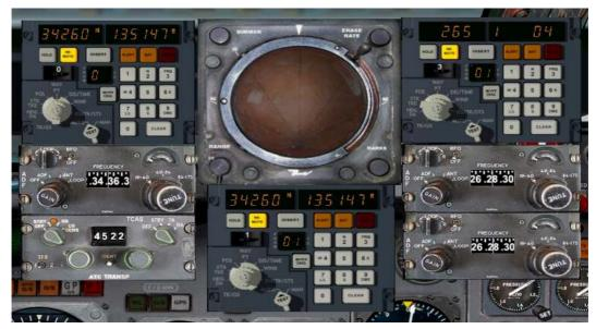
그리고 CDU의 POS를 확인해보면.. 이렇듯 모두 같은 POS이군요. 이제 From-To를 입력해줘야하는데 Waypoint CHG 버튼을 누르면 Waypoint CHG 버튼과 INSERT 버튼에 불이 들어옵니다. 그렇다면현재위치 즉 0과 다음 우리가 갈 위치인 1번 FIX 즉 01을 입력해줍니다. 그리고 Insert. 그렇다면CDU-1에서 보시는 것과 같은 화면이 나옵니다.
