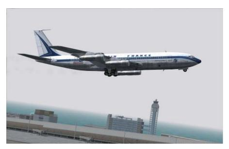
이제 이륙했습니다. INS는 FMC 처럼 SID/STARS가 제공되지 않기에 ATC의 RADAR VECTOR를 따라서 항로에 진입해야 합니다. ATC의 Radar Vector에 따르다 항로에 진입하라는 메시지를 던져줄겁니다.
