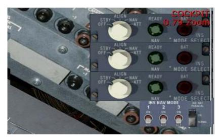
Captain Sim 707의 경우 패널을 Merge시킨 제작자가 Overhead Panel에 INS-CDU 전원 스위치를 위치시켜놨습니다. (실제 707에서도 오버헤드 패널에 전원스위치가 있습니다.) 지금 보시는 바와 같이 전원이 OFF 위치에 가 있습니다. 그렇다면 전원을 넣어줘야겠죠? 위에는 3개의 전원공급 패널이 있는데 위에서부터 각각 CDU-1, CDU-2, CDU-3의 전원을 공급해주는 패널들입니다. 위 세 개의 전원을 모두 공급해줘야 3개의 컴퓨터를 모두 사용할 수 있습니다.
