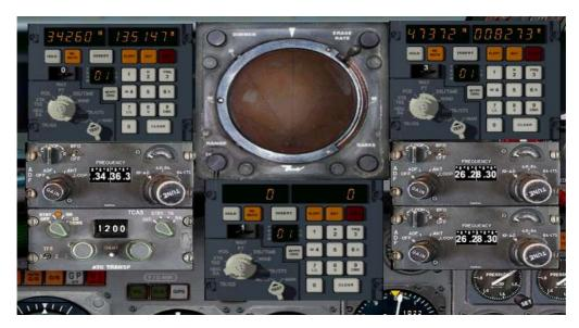
경도도 마찬가지입니다. Insert 불이 들어온 상태에서 그리니치 표준선을 기준으로 우측에 있다면 East 즉 6(E)를 눌러서 경도 좌표를 입력해줍니다. 서쪽이라면 West 즉 4(W)를 누른 후에 원하는 좌표를 넣어주시면 됩니다. 여기서 주의점. 경도는 위도와 달리 100을 넘어가는 수가 있기 때문에 경도의 첫자리가 예를 들어 동위 50.34.13이라면 입력할 때 꼭 050으로 시작해주어야 합니다. 그렇지 않으면 당신은 동위 503도의 이 세상에 존재하지 않는 곳에 있는 사람이 되어버리니깐요.
