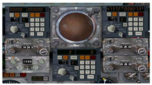
이렇게 3개의 INS CDU에 전원이 들어와 있습니다. 지금 3개의 컴퓨터의 CDU DISPLAY KNOB가 모두 다른 곳을 향하고 있는데요, CDU-1의 경우 WAY Point를 가리키고 있습니다. CDU2의 경우 POS, 즉 현재 위치를 가리키고 있는데, 실제에서는 마지막으로 전원이 꺼지기 전의 위치를 기억하여 다음에 켜질 때 자동으로 로딩 되는 걸로 알고 있습니다. 저 좌표는 제가 마지막으로 비행한 좌표인 것같군요. 즉 수정해줘야 합니다. CDU-3의 경우 현재 바람을 알려주는 위치에 놓여져 있습니다.
